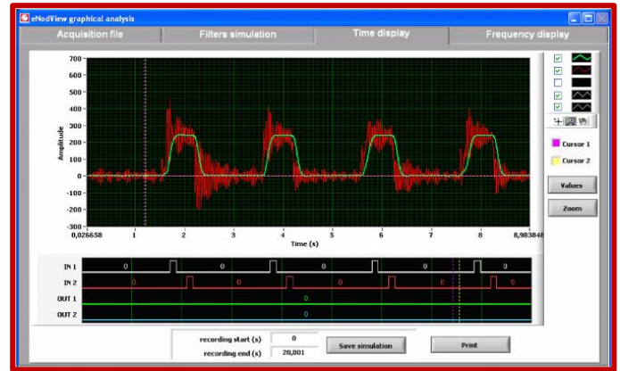
▲ Filtrage numérique par eNod4 et visualisation avec le logiciel eNodView Digital filtering by eNod4 and display with eNodView software
